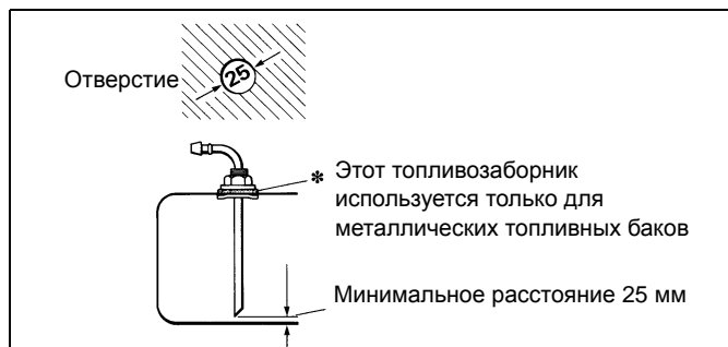
Рис.10: Топливозаборник Webasto из бака
