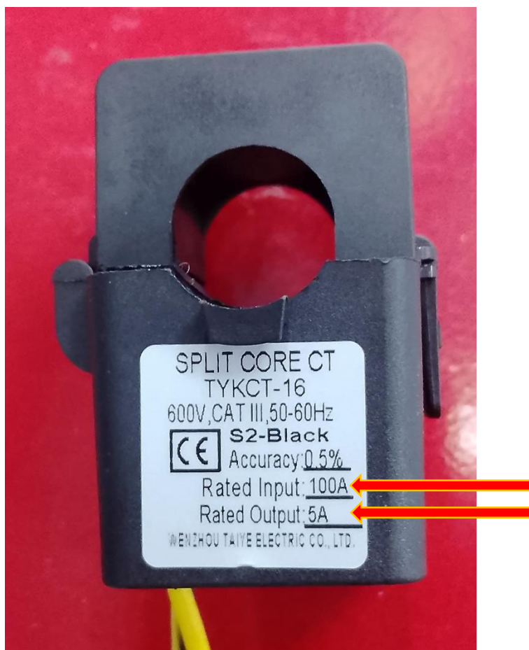
Рисунок 32. Маркировка на трансформаторе тока.
