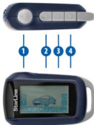
4-х кнопочный брелок с обратной связью и жидкокристаллическим (ЖКК) дисплеем
