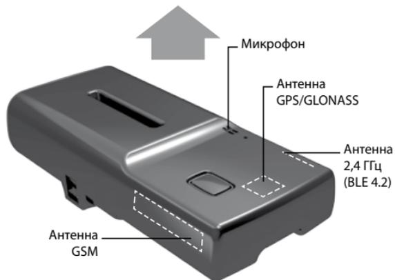
Модуль необходимо устанавливать лицевой стороной вверх (сторона с кнопкой «VALET» и светодиодным индикатором «LED»). Спутниковый сигнал GPS/ГЛОНАСС может проходить через пластик, стекло, однако металлические поверхности создают непреодолимую преграду для прохождения сигнала.
