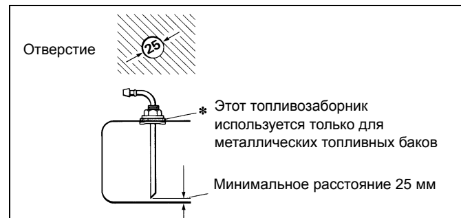
Рис.11: Топливозаборник Webasto из бака
