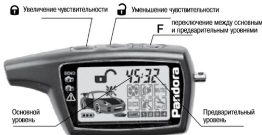
Короткими нажатиями на кнопку «1» производится увеличение тревожного уровня чувствительности (т.е. датчик будет срабатывать при меньших воздействиях на автомобиль), короткими нажатиями кнопки «2» производится уменьшение тревожного уровня чувствительности датчика удара.
